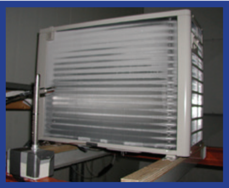
ScanMonts testlaboratorium 07/2012. Ny modell testas vid -30°C utomhustemperatur, avfrostningstest.
